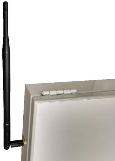
Vor dem Anschluss der Spannungsversorgung ist darauf zu achten, dass eine der mitgelieferten Stabantennen an der Aussenseite des Gehäuses befestigt ist.
